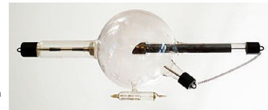
Устройство рентгеновской трубки
